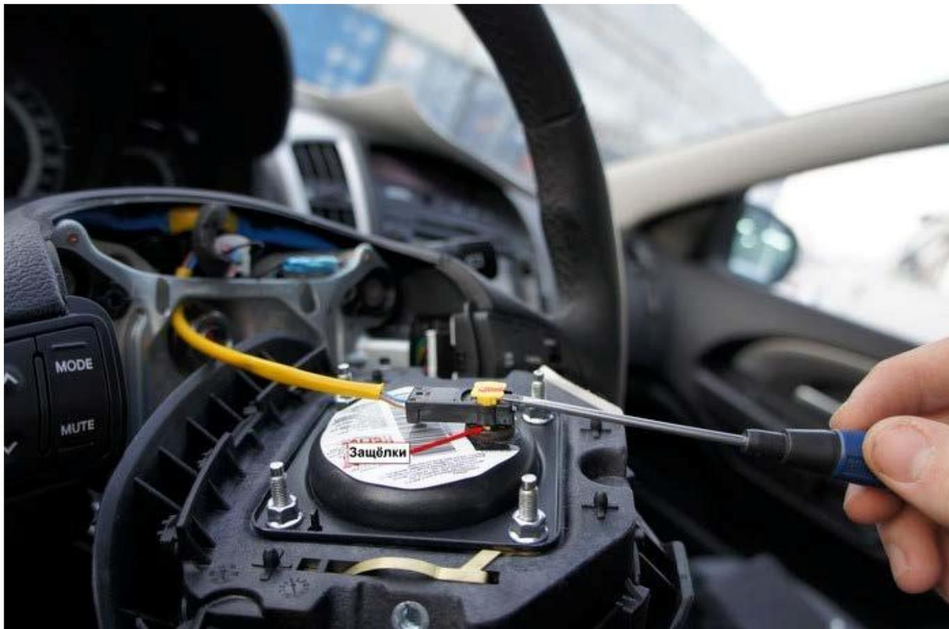
Немного наклоняя разъём в сторону защёлок вытаскиваем разъём, хоть фиксатор и поднят вверх, защёлки немного цепляются за корпус, так что аккуратно достаём разъём.
