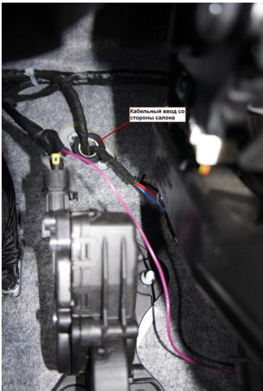
Далее снимаем левую накладку торпеды, там, где предохранители и откручиваем нижний щиток под рулём, там всё просто накладка на защёлках щиток на 4 винтах. Далее разбираем кожух на руле. Находим жгут который идёт от разъёма под рулём прям по центру.
