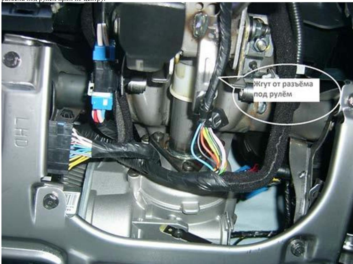
Внизу аккуратно снимаем изоляцию и расправляем провода, нам нужен синий, чёрный и красно-оранжевый. Небольшая проблема только с чёрным так как в этом жгуте два чёрных. Я нашёл его с помощью омметра и иголки. Нужный нам провод висит в воздухе, то есть не прозванивается на корпус а ненужный сидит на корпусе.
