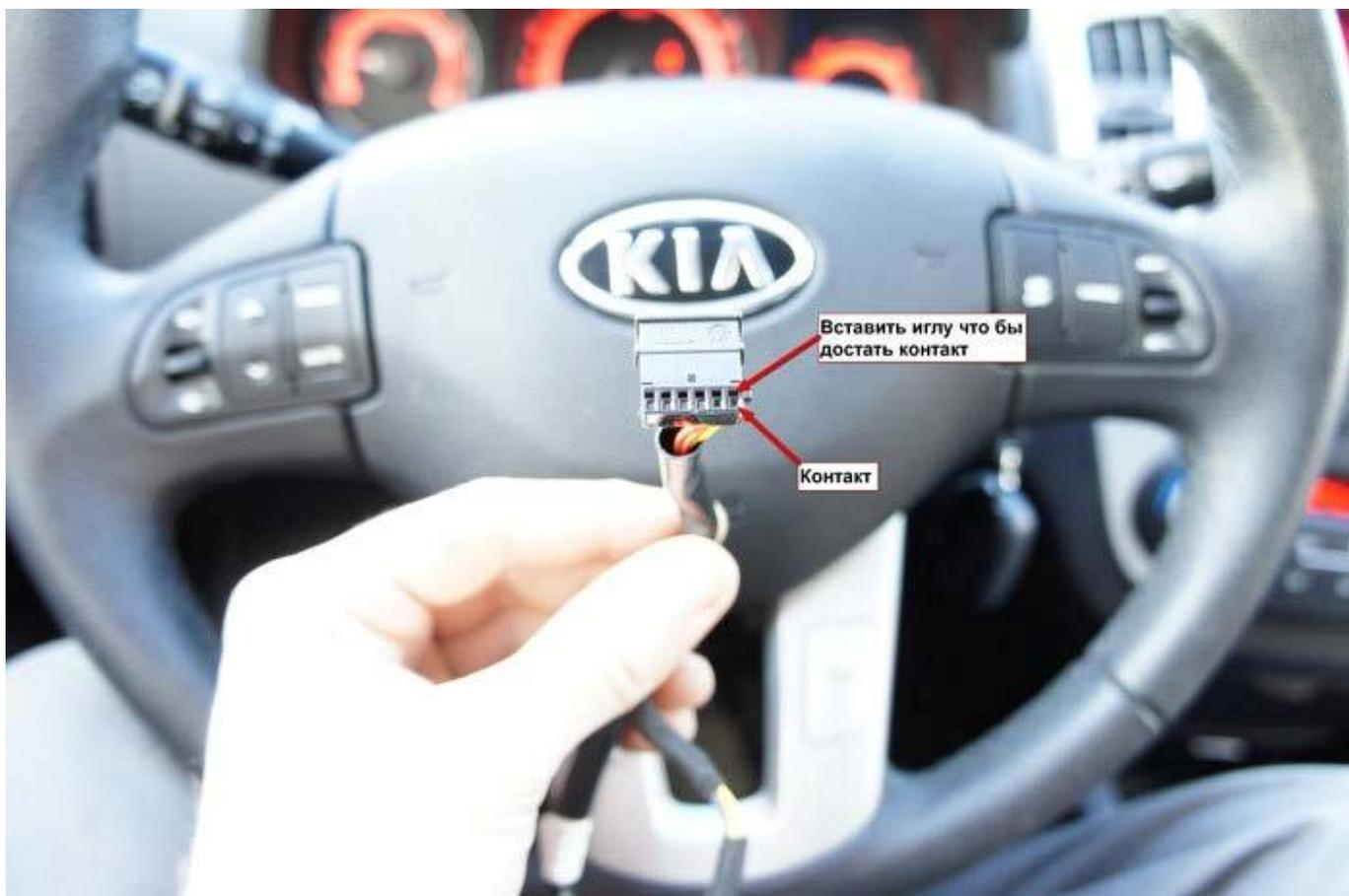
Вид на разъём со стороны шлейфа, со снятыми крайними контактами, 5 и 6 (Розовый и Зелёный), перед тем как вытащить записываем какой провод (по цвету) в каком гнезде находился, что бы аналогично установить в новом шлейфе.
