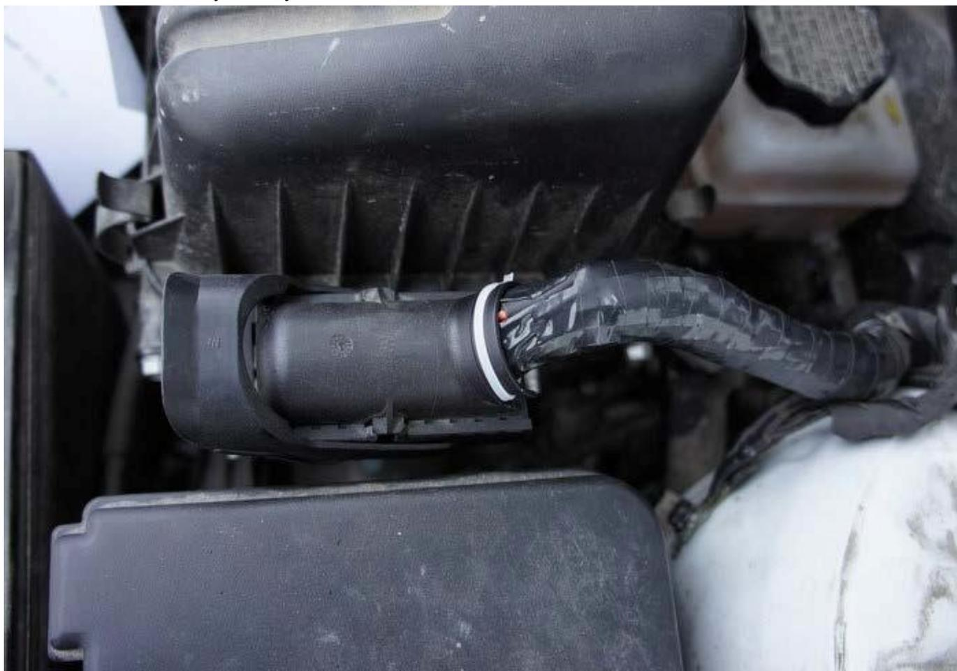
Открываем разъём, рукоятку вверх, и сдвигаем крышку по стрелке, в передней части имеется защёлка, как она работает я не успел понять, потому что из за -10 на улице она обломилась, если так же произойдёт, то не страшно, крышка достаточно плотно сидит, плюс хомутом к жгуту крепится и изолента.
