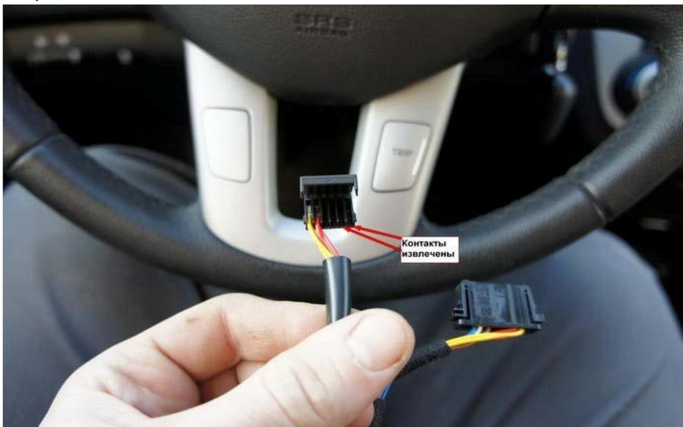
Открываем разъём тот что вставляется в барабан подвижного шлейфа, для этого со стороны обратной нажимному фиксатору необходимо поднять белый фиксатор контактов, отверткой или иголкой, у фиксатора имеются две защёлки по бокам разъёма. Выдирать его с корнем не надо!!! Он подымается наполовину, полностью достаётся только если достать ВСЕ контакты.
