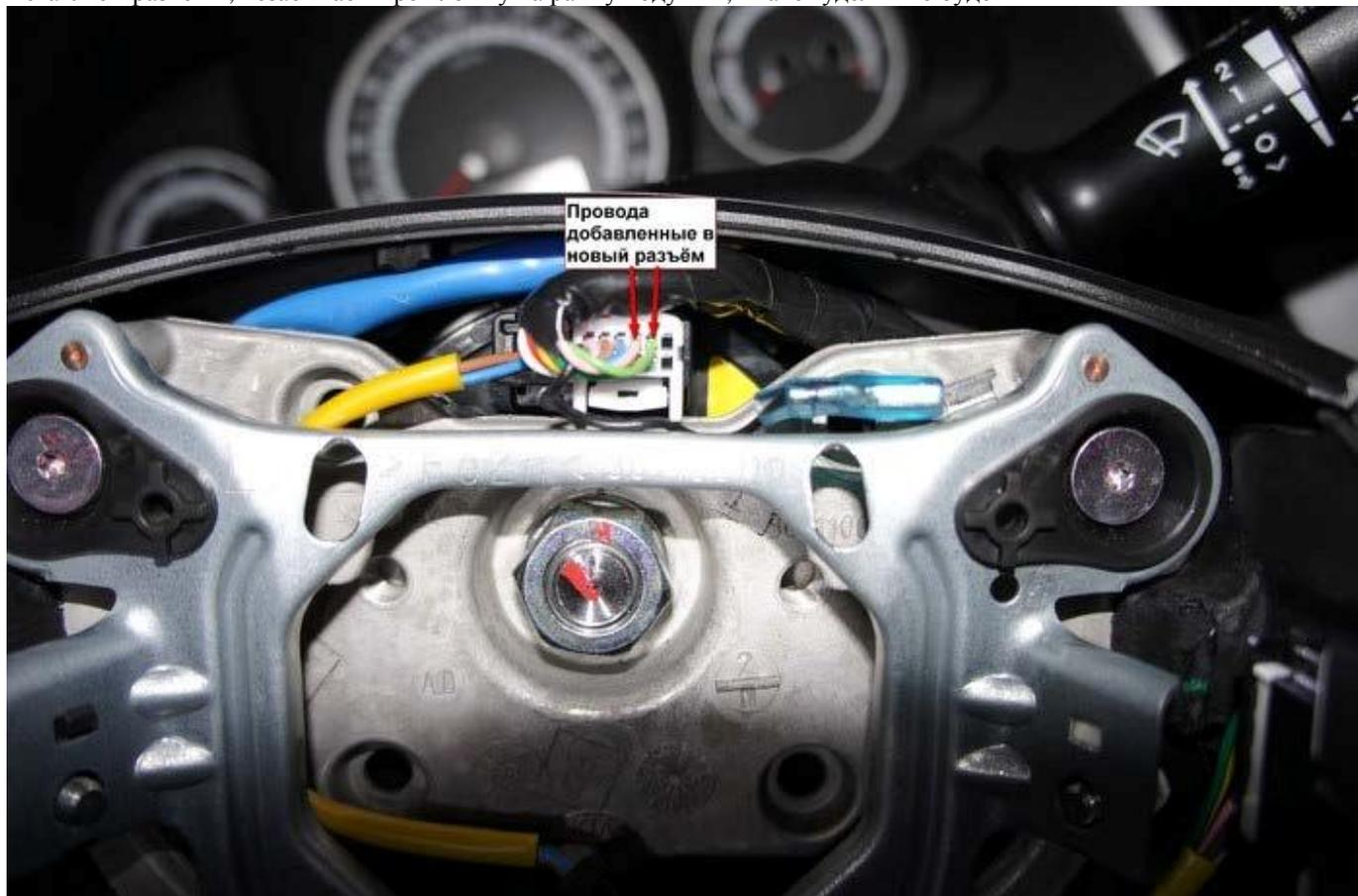
Подключаем подушку, собираем всё как было, подключаем аккумулятор, и проверяем работу левой части кнопок и кнопки TRIP.
