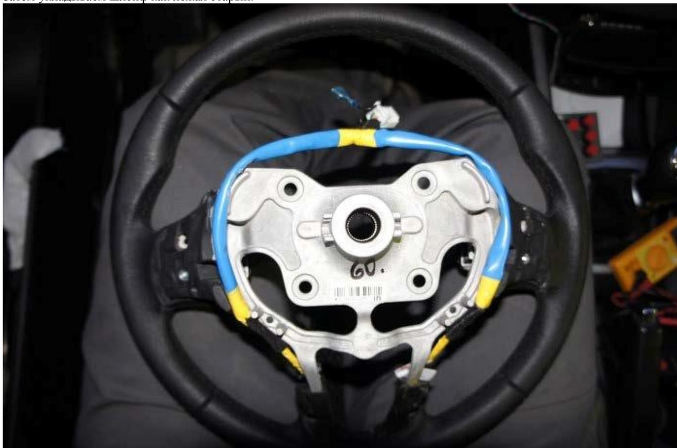
Для снятия кнопок необходимо открутить еще два винта с задней стороны руля, затем достать из них разъёмы, потянуть на себя и извлечь, затем установить новые, вставить разъёмы, закрутить винты. С винтами внимательно, не вкрутите в те отверстия, которые крепят кожух руля
